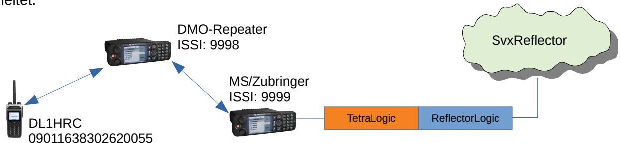
Bild 30: Prinzip DMO-Repeater und „Audio-Zubringer“
