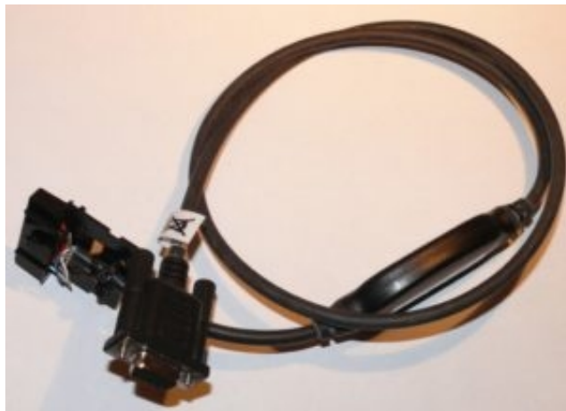
Bild 24: Aktives Datenkabel für einen RS232-Anschluß
