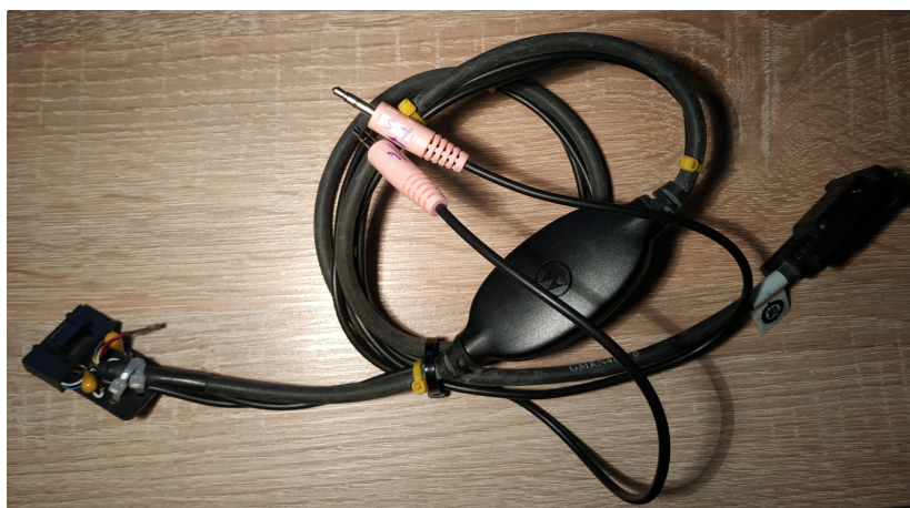
Bild 26: Ein um die Audioanschlüsse (Tx+Rx-Audio) erweitertes aktives Datenkabel, die C's können auch weggelassen werden
